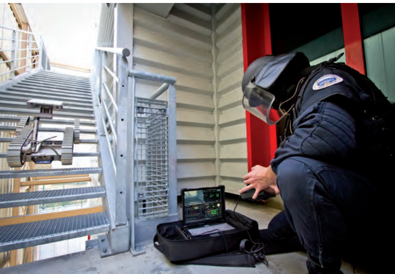
Le technicien de la Section des Moyens Spéciaux effectue une reconnaissance en pilotant un robot équipé de moyens vidéo jour/nuit et thermique.
